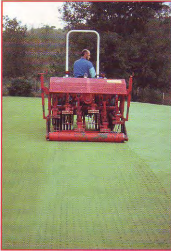
Décompactage de green avec Vertidrain de 1,5 m équipé de dents, diamètre 12 mm avec aucune déformation du green (Photo A T E)
